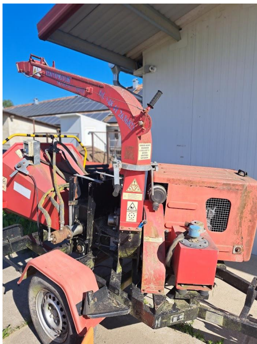
3.12 sz. Gallyaprító, Teknamotor Skorpió 160SD
